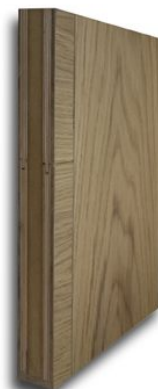
KONSTRUKCJA DREWNIANE DRZWI DREWNIANE, WARSTWA WEWNĘTRZNA: SKLEJKA BRZOZOWA PŁYTA WYGŁUSZAJĄCA WARSTWA ZEWNĘTRZNA: LITY DĄB
